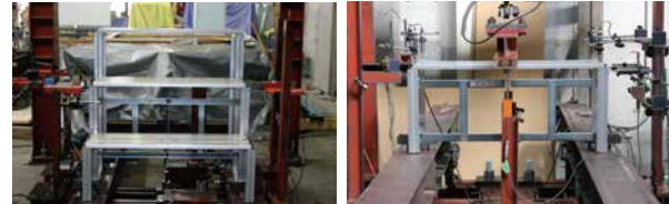
●ひな段セット製品水平荷重試験 （3段5連セットD400タイプ場合） 最大値：1,621kgf
