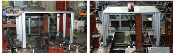
●ステージセット製品水平荷重試験 （幅4550×奥行2700×高さH900mm場合） 最大値：2,214kgf
