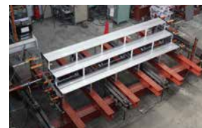
●ひな段セット製品水平荷重試験 （3段5連セットD400タイプ場合） 最大値：1,621kgf
