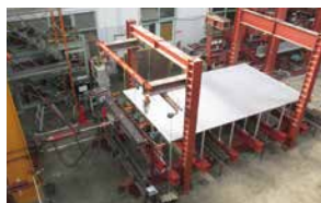
●ステージセット製品水平荷重試験 （幅4550×奥行2700×高さH900mm場合） 最大値：2,214kgf
